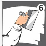
**6** Шпатлевку БОЛАРС «Выравнивающая» нанесите стальным шпателем на основание слоем от 1 до 10 мм. Для получения более толстого слоя допускается шпатлевание в несколько слоёв. Последующий слой нанесите после полного высыхания предыдущего, предварительно прогрунтовав поверхность грунтовыми составами БОЛАРС.
