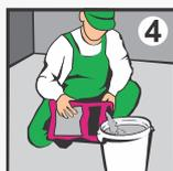
**4** Для подготовки раствора залейте водопроводную воду комнатной температуры в чистую ёмкость из расчёта 0,24 - 0,28 л воды на 1 кг сухой смеси.
